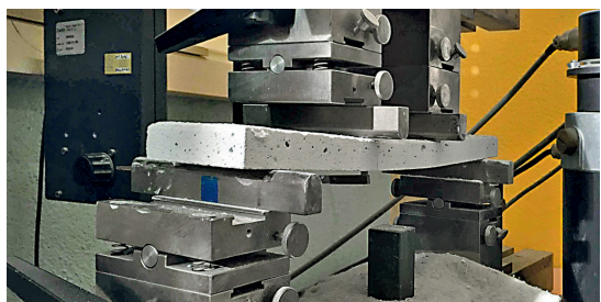
Essai de flexion d'un composite ciment-verre selon EN 1170-5
